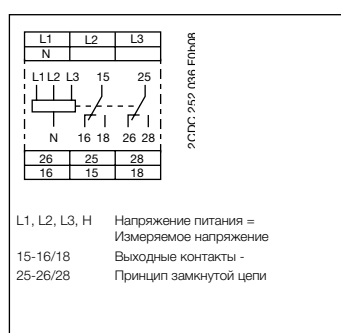
Схема подключения CM-UFS.2
