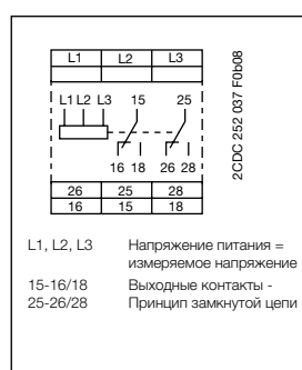
Схема подключения CM-PAS.x1
