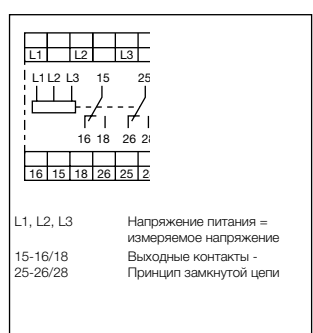
Схема подключения CM-MPN.x2
