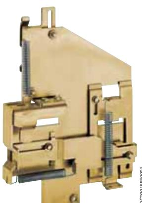
Блокирует открывание двери секции, если автоматический выключатель включен (и установлен - для выкатных автоматических выключателей), и блокирует включение автоматического выключателя, когда дверь секции открыта.
