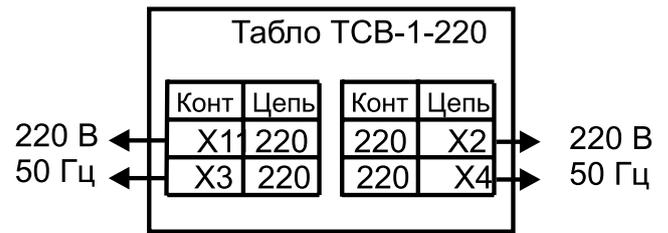
Рис. 3. Схема подключения Табло модели ТСВ-1-220 (питание переменным напряжением 220 В, 50 Гц)
