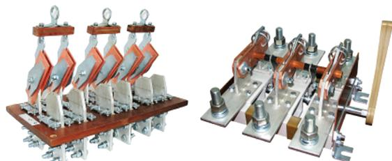
Предназначены для пропускания номинальных токов и нечастых (до трех раз) неавтоматических коммутаций электрических цепей без нагрузки номинальным напряжением до 1000 В переменного тока частоты 50, 60 Гц и номинальным напряжением до 1000 В постоянного тока в устройствах распределения электрической энергии.
