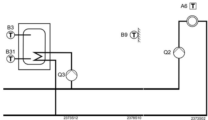
Тип оборудования №12 Регулирование насосной отопительной зоны.
